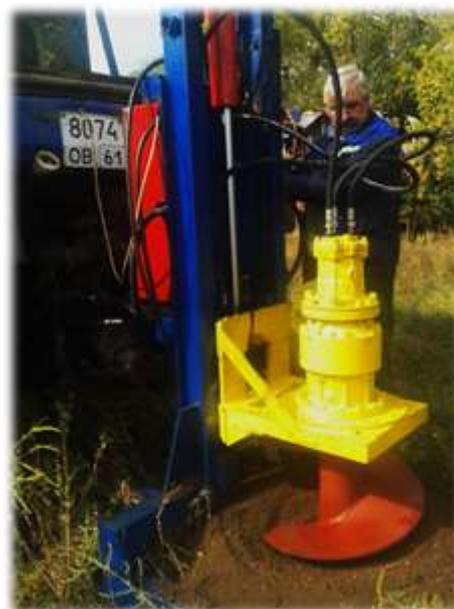
Бур устанавливается на трактор МТЗ 82
